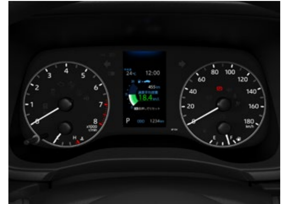
アナログメーター+4.2インチTFTカラーマルチインフォメーションディスプレイ ■写真はガソリン車。
